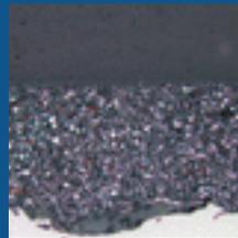
Nach 7 Tagen wurde eine zweite Schicht ZINGA® auf den Goldstaub aufgetragen. Die Homogenisierung beider Schichten wird dadurch belegt, dass der Goldstaub tatsächlich in beide Schichten eingebunden wurde.
