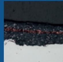
Mit einer Zinkstaubfarbe auf Epoxidharzbasis wurde der Test wiederholt. Die Schicht aus Goldstaub bleibt zwischen beiden Lagen intakt und deutlich sichtbar. Beide Schichten bleiben voneinander getrennt.
