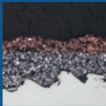
Ein dünner Film Goldstaub wurde auf die erste Schicht ZINGA® appliziert und per Mikroskop abgelichtet.
